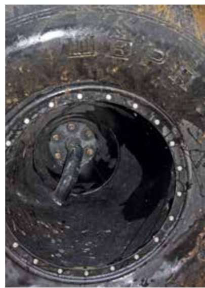
Через эту трубу, выходящую из ступицы, и происходит накачка/спуск колес, происходит очень быстро!
